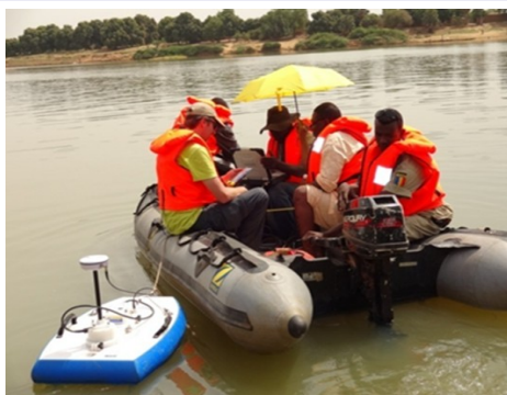
Mesure de débits du Chari à N'Djamena
